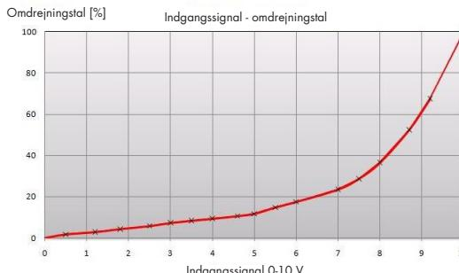
Indgangssignalet er direkte proportionalt med rotorens effektivitet, hvilket betyder at indgangssignal og omdrejningstal er i overensstemmelse med det tilsvarende diagram.
